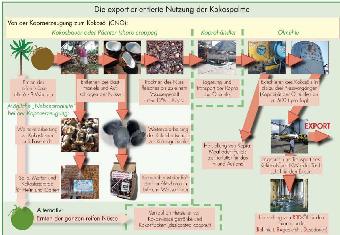
Abbildung: Schematische Darstellung des Produktionsprozesses von der Kokosnussernte über die Kopraproduktion zum Kokosöl (Quelle: B. Schütze).
